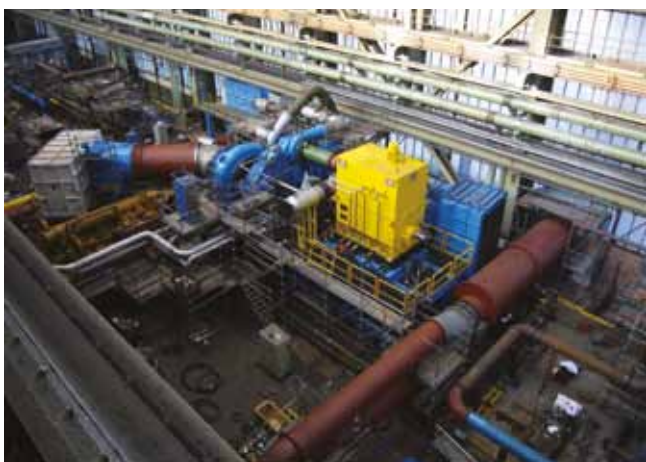
Suministro: 14.000 kW, 10.000 V, 4 polos, carcasa 1000 Aplicación: Laboratorio de test
