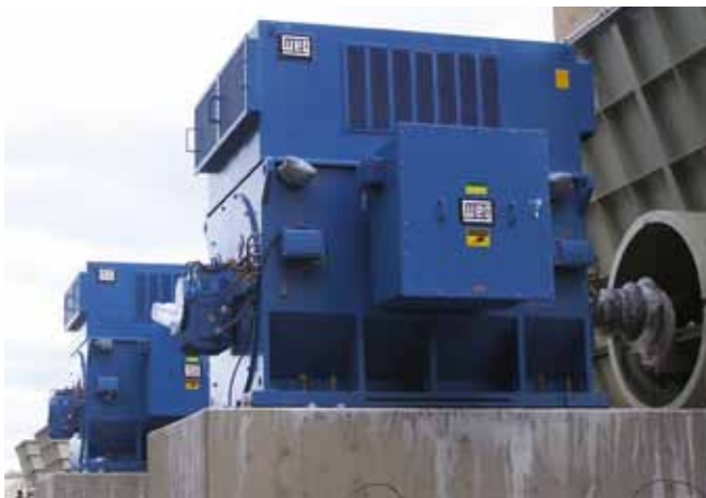
Suministro: 9.900 HP, 13.200 V, 8 polos, carcasa 900 Aplicación: Ventilador
