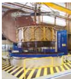
Impregnación a vacío (VPI)
